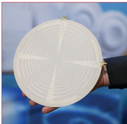
Fig. 1 Log periodic dipole array antenna on a WavePro substrate.
